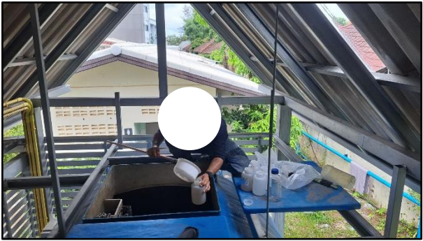
จุดเก็บตัวอย่างน้ำทิ้งหลังบำบัด (บ่อพักน้ำทิ้งของระบบบำบัดน้ำเสีย)
